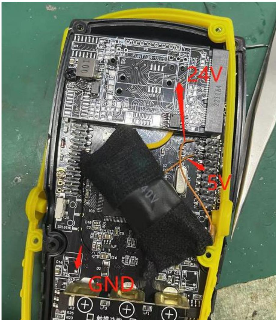
24V 升压模块使用前先逆时针旋转 15 圈以上，再顺时针升压，调节至输出 24V 后再装在手持机主板上！
