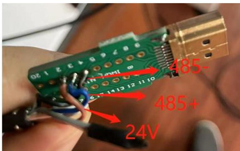
如上图所示，使用 HDMI 转接板作为 HDMI 线缆时，对应的焊接引脚定义：
