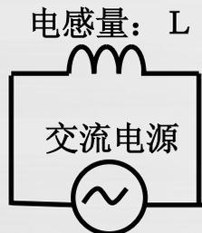
电压，电流和电感量的关系式经解析后，能得出纯电感器阻抗，与频率和电感量成正比。
