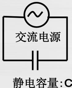
电压，电流和静电容量的关系式经解析后、纯电容器的阻抗，与频率和静电容量成反比例。
